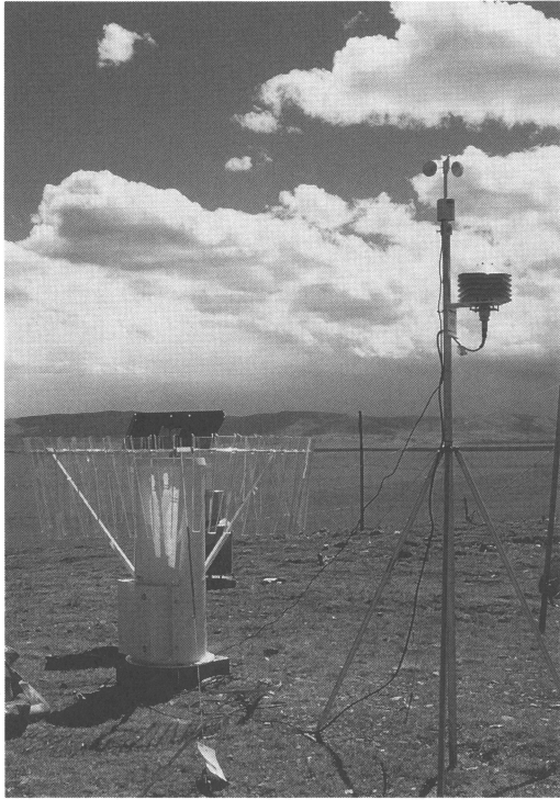
第6図 重量式降水量計 (アメリカ・ETI社製)
