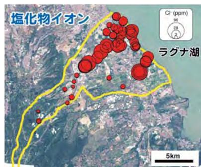
図4 サントラオ集水域における、河川水中の塩化物イオン濃度分布。中流域(工業地域)で濃度が急激に高くなる
