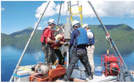
写真1 ララ湖でのボーリング調査風景
