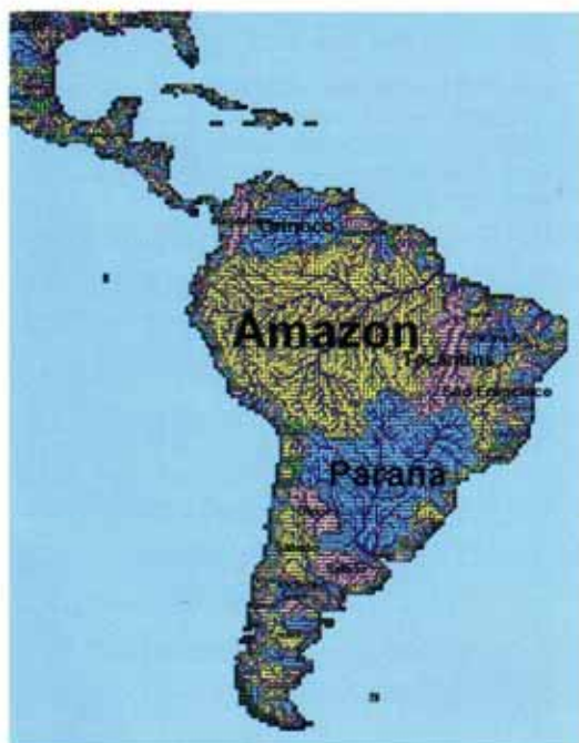
▲ 地球上の全陸地を0.5度(約50km)格子で覆い、大規模の河川によってどのように水が海洋まで流出するかの経路を示したグローバルな河道網情報(南米)。陸地表面での水の動態を表現する数値モデルと組み合わせられて、利用可能な水資源量を算出するのに用いられる。
