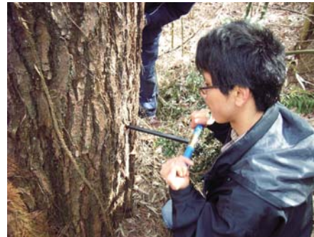
写真2 樹木年輪試料の採取方法
