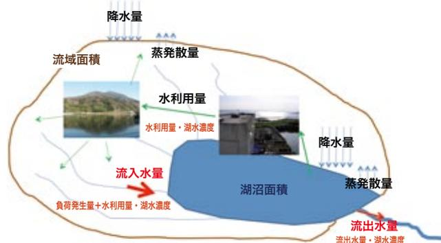
図 下流汚染蓄積型湖沼での水と物質の循環
