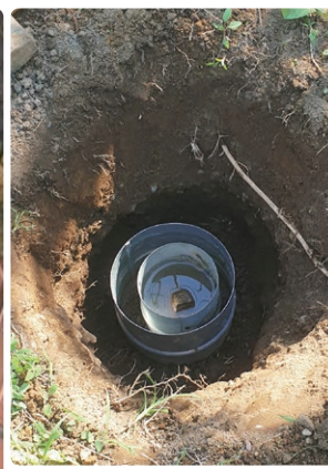
図9 花の木公園の浸透能測定箇所(左)と測定状況(右)
