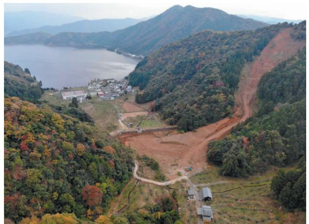
写真3 豪雨時に湖岸の急斜面で発生した土砂崩れ(2013年9月)
