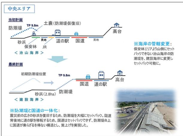
大谷海岸中央エリアの国道嵩上げと砂浜再生の仕組み
