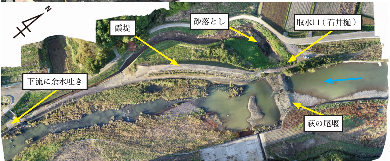
取水口(石井樋)
