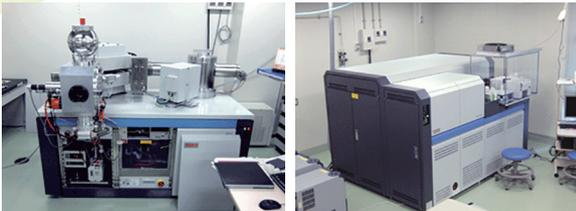
表面電離型質量分析装置 (TRITON) マルチコレクタ ICP-MS (NEPTUNE plus)
