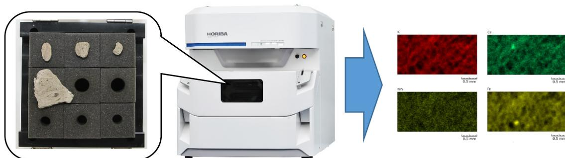
収集した軽石と独自開発の治具（左）／蛍光X線分析装置（中）／成分分析のイメージ図（右）
