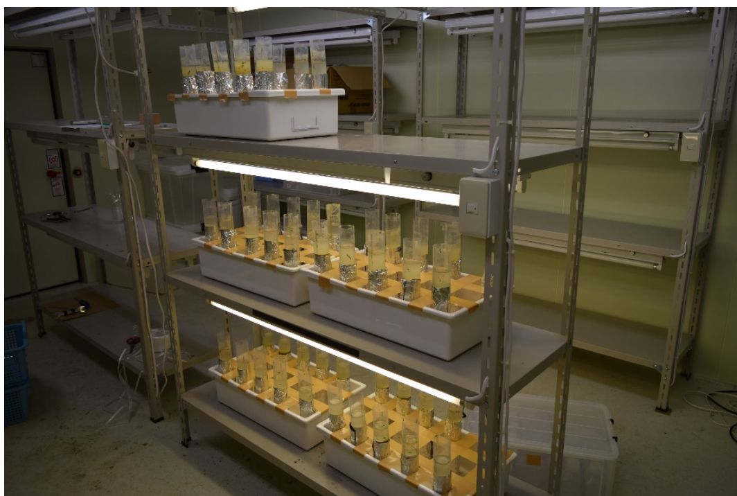
写真2 培養実験の様子。採取した土壌と灌漑水をプラスチックケースに詰めて30日間培養室で培養した。室内の明かりと温度は5月の現地状況を再現するように設定している。
