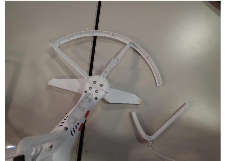
地球研グラウンドで飛行練習中にフェンスと機体との距離感が分からなくなり、フェンスと激突。スピードを出しすぎていたのも要因。結果、2m程度の高度から墜落し、プロペラとプロペラガードが破損。予備の部品に付け替えたところ、問題なく飛行した。スピードを控え、常に障害物との距離を認識して飛行させるのが重要。
