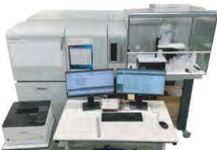
高分解能マルチコレクター誘導結合プラズマ質量分析装置 (MC-ICP-MS)
