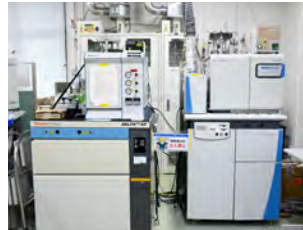
熱分解型元素分析装置付き安定同位体比質量分析計 (TC/EA-IRMS)
