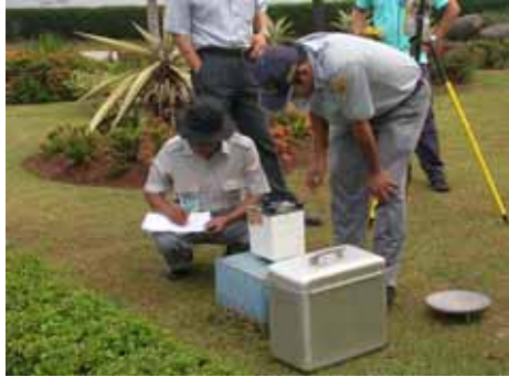
Fig. 2 Relative gravimeter (LaCoste and Romberg gravimeter).
