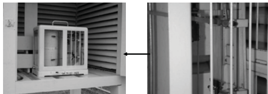
馬の毛を用いた湿度の測定
