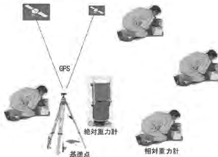
図1. 絶対重力計、相対重力計、GPSの組み合わせによる測定
