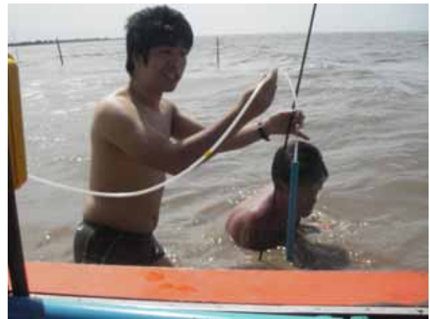
図-6 ピエゾメータによる再循環水の採水
