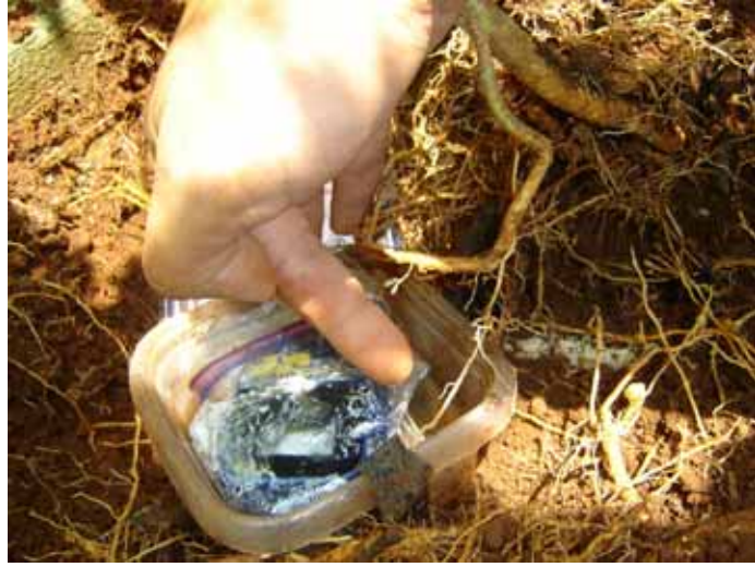
図3 水にを使った土壌温度の記録計
