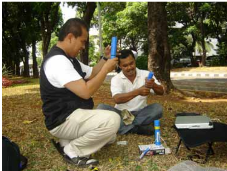
図2 孔内温度を計測する水温計からのデータ回収
