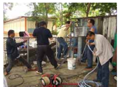
写真3: 採水風景、重量ポンプの引き上げにはDGRのスタッフが4名フルパワーで活動
