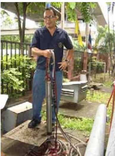
写真1: 採水に用いたGRUNDFOSの大型ポンプ
