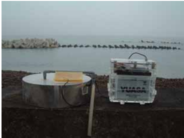
図 2 . 測定機器 (地下水湧出量計) (静岡市用宗にて撮影)
