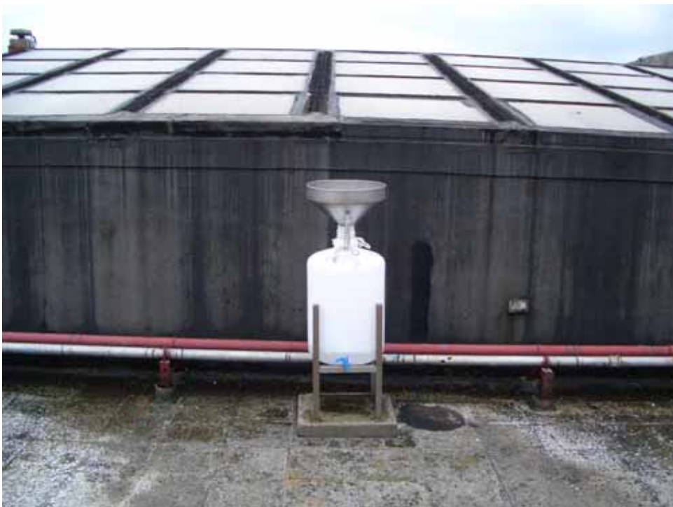
写真 4 台湾地球科学研究所設置の雨水コレクター サンプル番号 TP14
