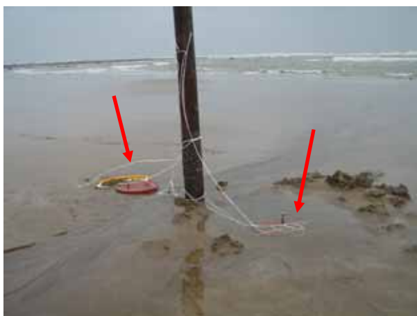
図 5 . 地下水湧出量の測定
