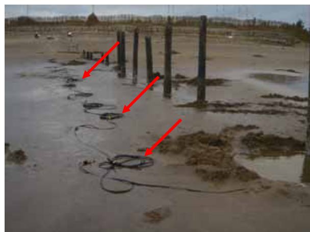
図 6 . 地下の塩水淡水分布測定
