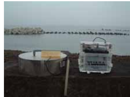
地下水流出量を測定する装置
