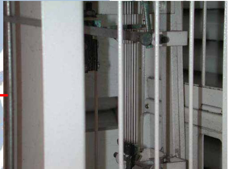
馬の毛を用いた湿度の測定
