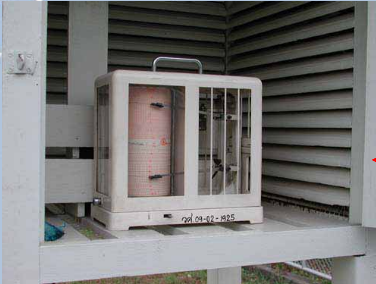
馬の毛を用いた湿度の測定
