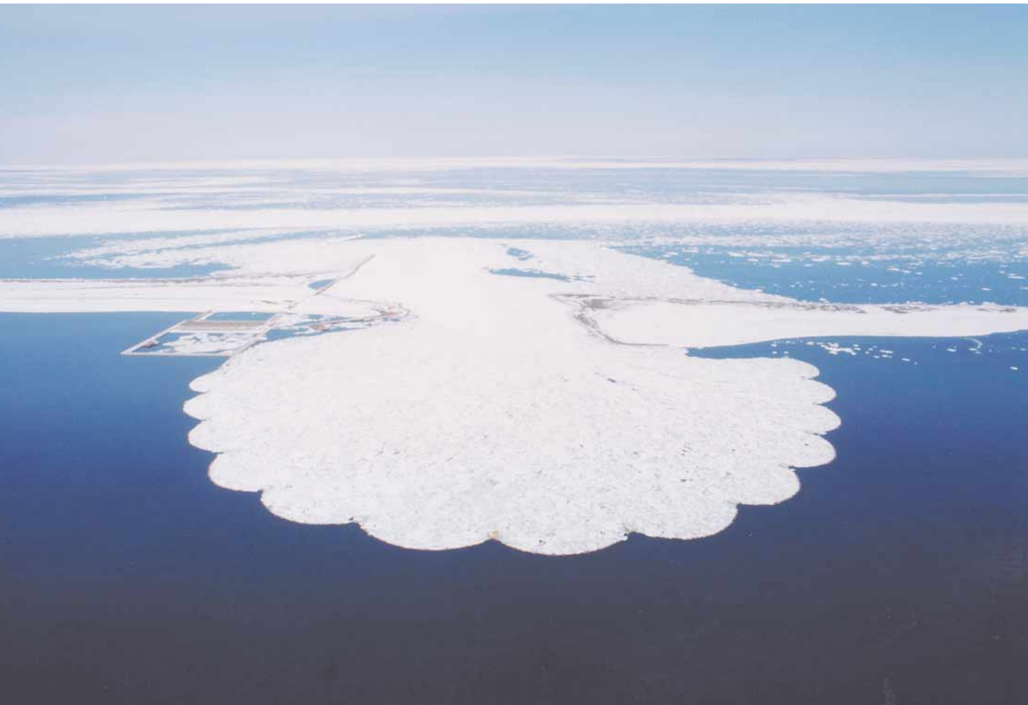
31. サロマ湖では、毎年1月から3月にかけて湖内に押し寄せてくる流氷の流入を阻止するため、アイスブーム（流氷流入対策施設）を設置し、ホタテガイやカキの養殖施設・刺し網などの漁具の被害を防いでいます。[北海道開発局／サロマ湖]
