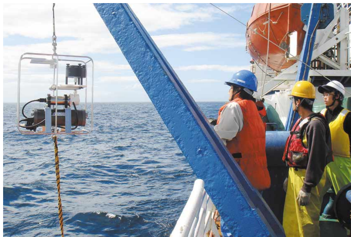
4.海水中の粒子を集める装置によって観測している様子。[森島秀太／サハリン沖オホーツク海]
