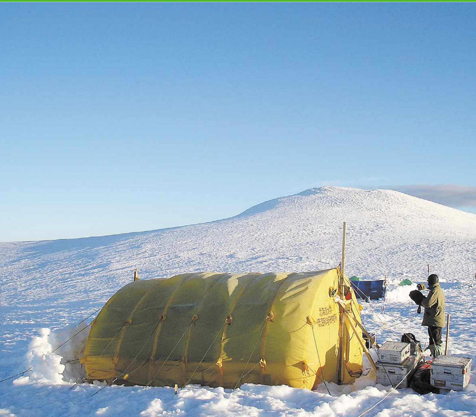
25.カムチャツカ半島中央(スレドニー)山脈最高峰・イチンスキー山山頂氷河での掘削風景。2006年8月に岩盤まで到達する115mのアイスコアが採取されました。 【的場澄人/カムチャツカ半島】
