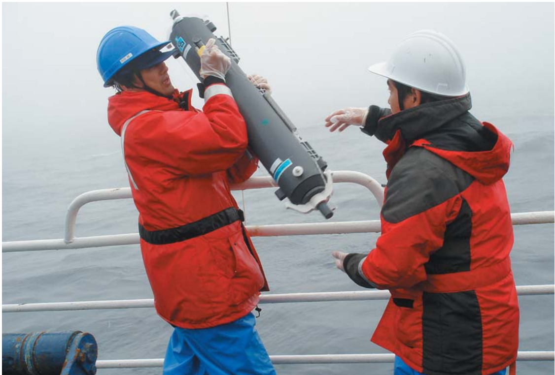
5. 为了测量铁分，谨慎采取清洁的海水[森岛秀太／库页岛远海水域鄂霍次克海]
