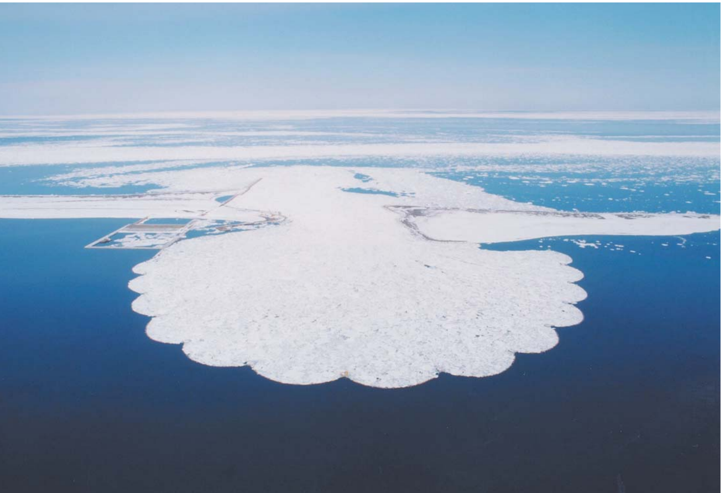
31. 在佐吕间湖, 每年1月至3月之间, 为了阻止涌来流入的流冰, 设置防冰柵 (流冰流入对策施設), 以预防扇贝或牡蛎的养殖设备、刺网等渔业工具受到损失。[北海道开发局/佐吕间湖]
