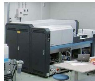
二重収束型高分解能 ICP マルチコレクタ質量分析計
