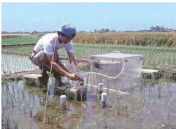
土壌から発生する温室効果ガスの計測 クローズドチャンバー法
