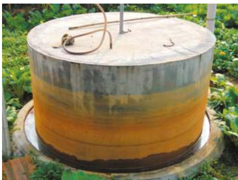
小規模メタン回収システム：（右）醗酵槽（左）ガスタンク（楠部孝誠氏撮影）
