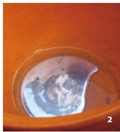
1 金鉱石と水銀を混ぜるミル 2 ミルで混合してできた水銀金アマルガムと液体水銀。 中央のかたまりがアマルガム 3 アマルガムを焼くストーブ 4 水銀を気化させたあとに残った金
