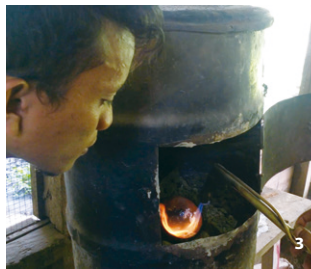
1 金鉱石と水銀を混ぜるミル 2 ミルで混合してできた水銀金アマルガムと液体水銀。 中央のかたまりがアマルガム 3 アマルガムを焼くストーブ 4 水銀を気化させたあとに残った金
