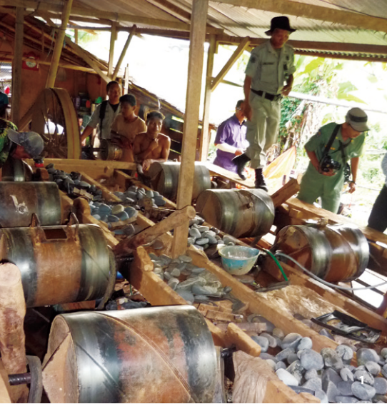
1 金鉱石と水銀を混ぜるミル 2 ミルで混合してできた水銀金アマルガムと液体水銀。 中央のかたまりがアマルガム 3 アマルガムを焼くストーブ 4 水銀を気化させたあとに残った金
