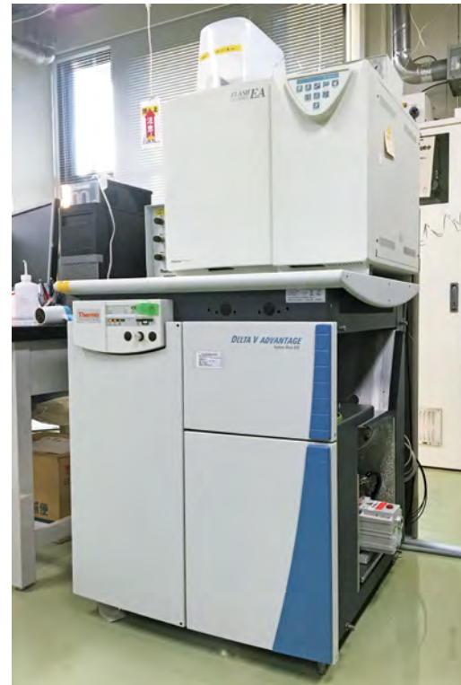
炭素・窒素同位体比分析装置。上の装置（Flash-EA）によって、サンプル中にふくまれる炭素と窒素を分離し、下の機械でそれぞれの元素の同位体比を分析する
