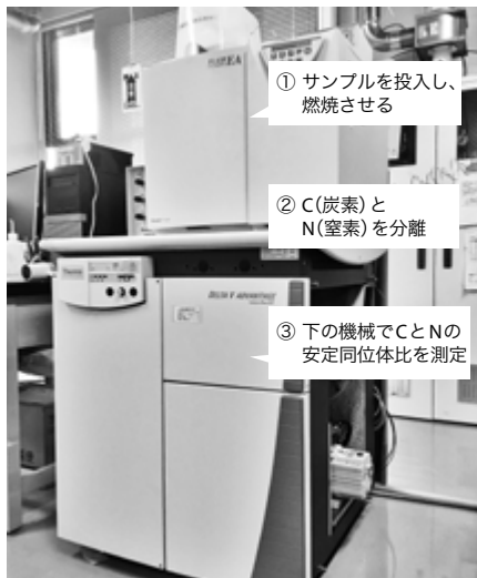
上の装置 (Flash-EA) によって、サンプル中にふくまれる炭素と窒素を分離し、下の機械でそれぞれの元素の同位体比を分析する
