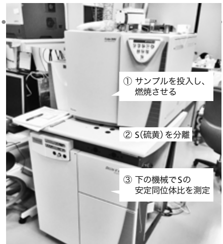
炭素・窒素同位体比分析装置としくみはほぼ同じ。上の装置 (Flash-EA) によって、サンプル中にふくまれる硫黄を分離し、下の機械で同位体比を分析する
