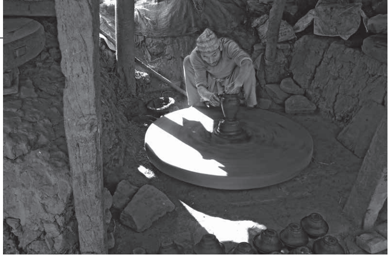
ネパール、バクタブルの陶器づくり。手まわしの轆轤で成形する(2015年1月)
