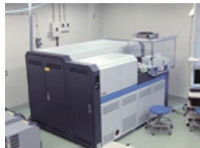
表面電離型質量分析装置 (TRITON) マルチコレクタ ICP-MS (NEPTUNE plus)
