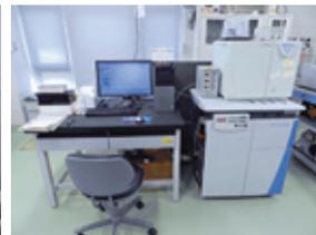
誘導結合プラズマ質量分析装置 (ICP-MS 7500cx)
