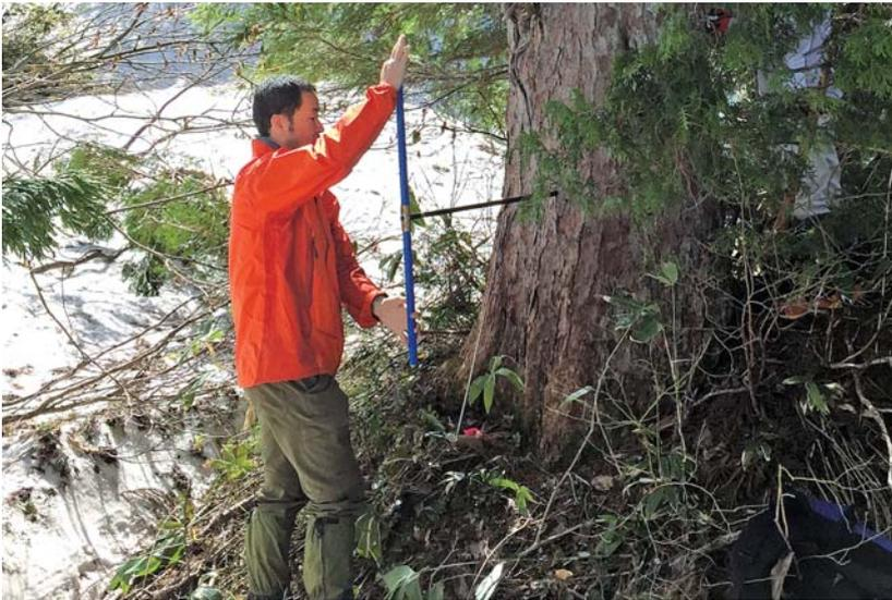
写真1 成長錘を用いた年輪コアの採取
