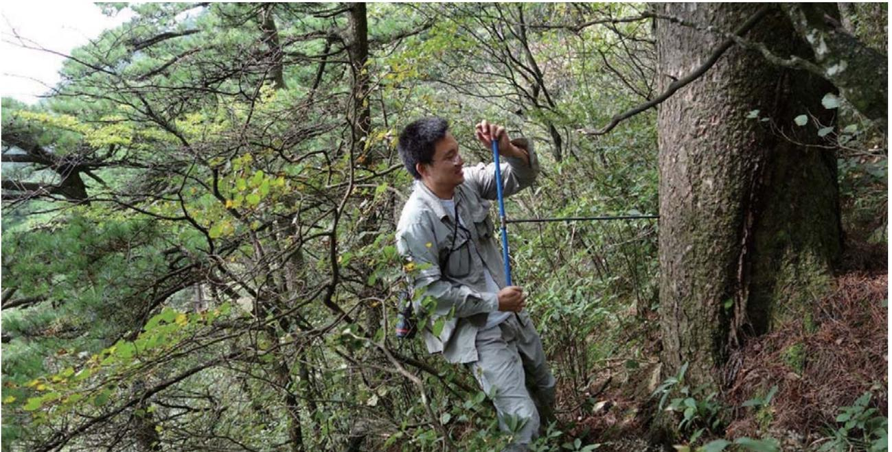
写真1 成長錐を用いた年輪コアの採取
