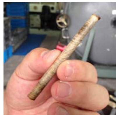
採取された年輪コア （このあと1mm厚の薄板に加工してセルロースを抽出し、年層ごとに酸素同位体比を分析した）
