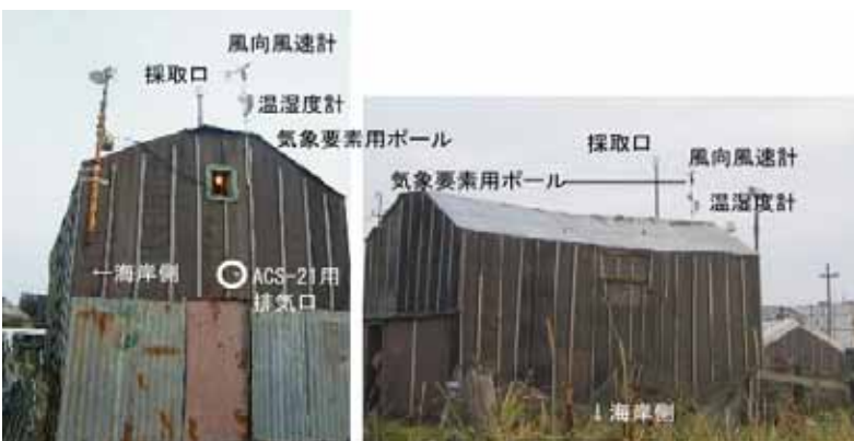
写真1 自動連続エアロゾル捕集装置設置後
